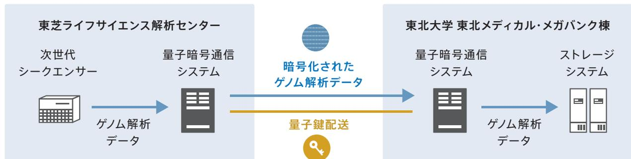
図：開発したゲノム解析データ転送システムの概要
